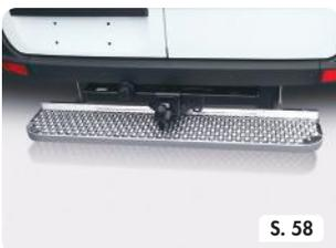
Serie HTF | Hecktrittstufe aus Stahl feuerverzinkt
