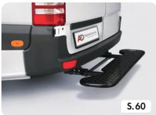
Serie HQ | Einschiebbare Hecktrittstufe
