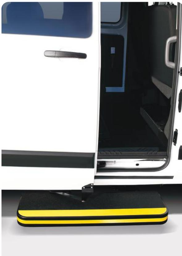
Trittstufe bereits komplett ausgefahren, wenn die Tür halb geöffnet ist
